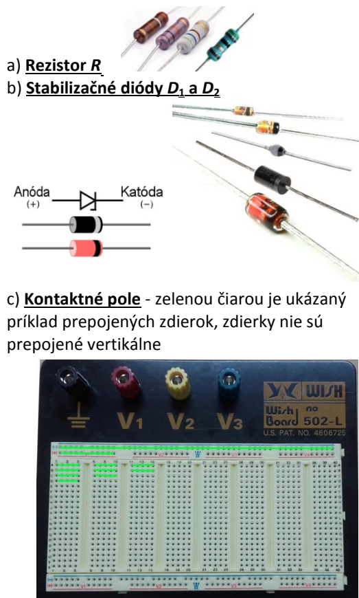
Obr. 1 Súčiastky, zariadenia a prístroje potrebné k meraniu
