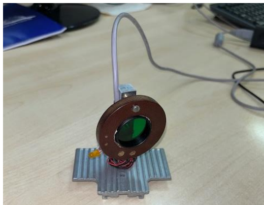
Obr. 2. Podstavec so zabudovanou laserovou diódou a zeleným filtrom pre zníženie jej intenzity.
