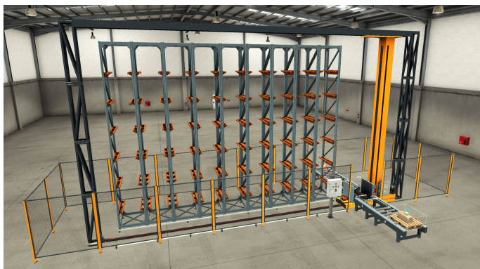
Obr. 2: Skladový systém od softvéru Factory IO
