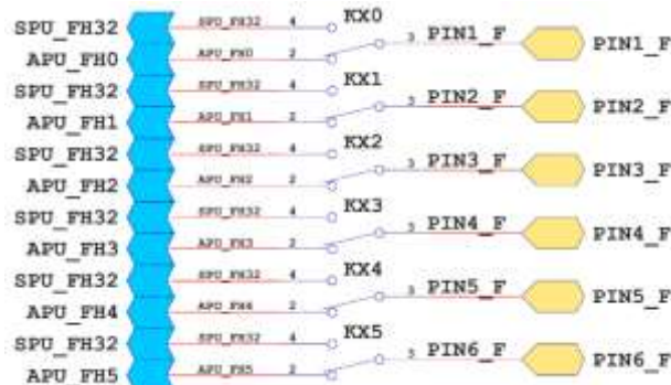
Obr. 2. Pripojenie APU a SPU zdrojov prostredníctvom relé na vodivé cesty prvku pre vytvorenie kontaktov.
