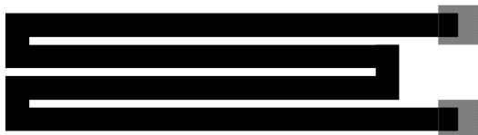
Obr. 1 Navrhnutá štruktúra senzora ohybu technológiou atramentovej tlače.
