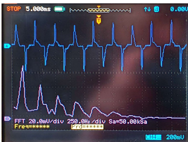
Obr. 7: Nameraný časový priebeh (hore) a harmonické spektrum prúdu N vodičom (dole) pre trojicu laptopových napájacích zdrojov v rámci laboratórneho merania.
