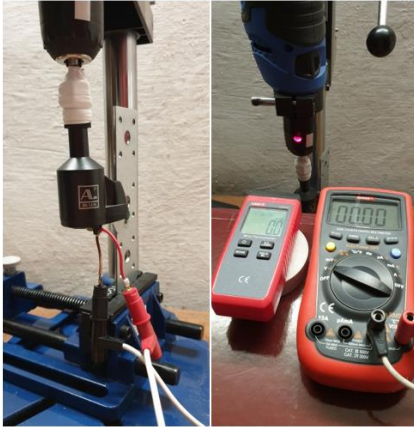
Obr. 8. Meranie závislosti generovaného napätia od frekvencie otáčok dynamu [4].
