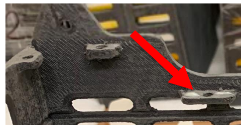
Obr. 14 Detail úchyty na obale s nízkou mechanickou pevnosťou (nutnosť dodatočného prilepenia)
