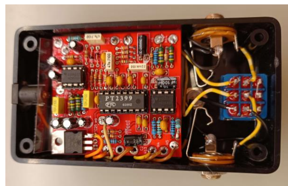
Obr. 14. Doska plošných spojov vo vnútri krabičky spolu s potenciometrami, indikačnou LED diódou, audio konektormi a nožným prepínačom vytvárajú kompletný efektový pedál.
