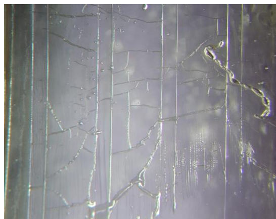
Obr. 6. Popraskanie SU-8 vrstvy na PDMS substráte.
